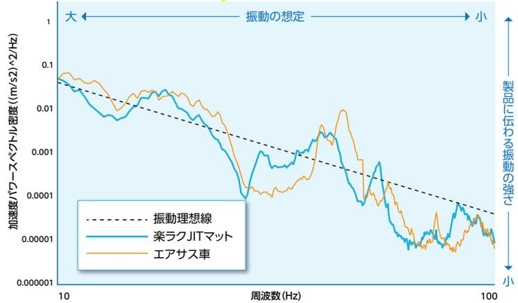
※日本産業規格「JIS Z 0200 包装貨物・性能試験方法」に準じ、振動試験機を用いて実施[ボックスチャーター(株)調べ]
